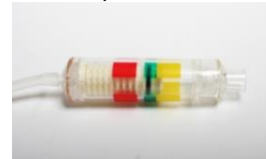
Rysunek 11: Zawór pilotujący mankieta w zielonej strefie
