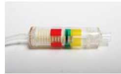
Afbeelding 11: Zwarte lijn in groene zone van controleklep
