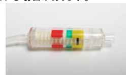
図12: 黄色ゾーンにあるカフパイロットバルブ
