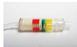
Afbeelding 11: Zwarte lijn in groene zone van controleklep
