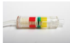
Obrázek 11: Ventil manžety v zelené zóně
