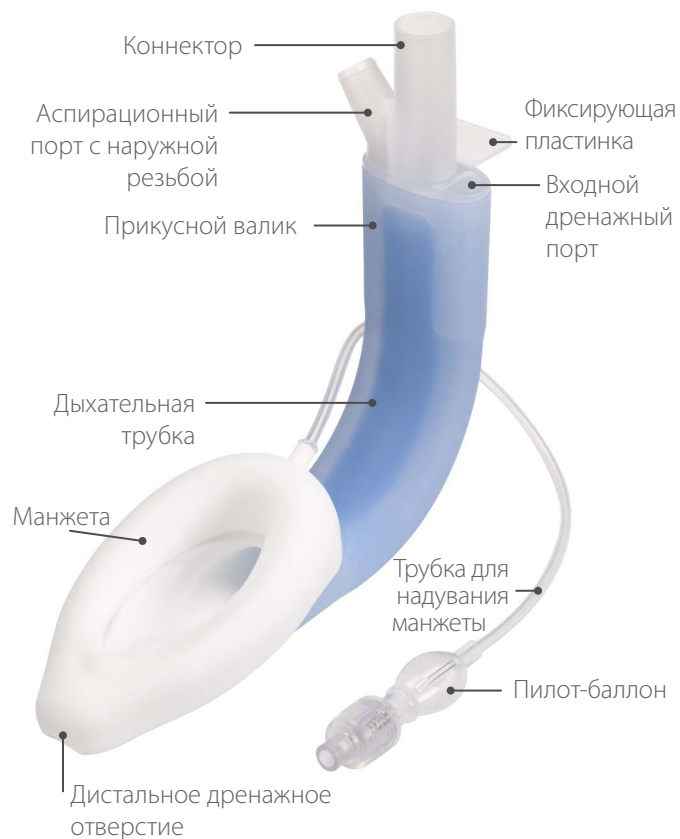
Рис. 2. Компоненты маски LMA Protector™ Cuff Pilot™
